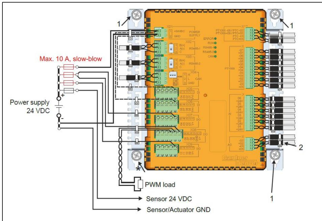
Figure 13: IO Module Wiring
